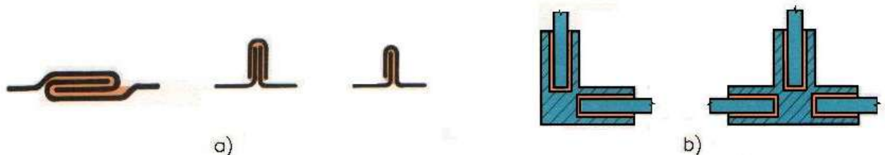
Obr. 141 Konstrukce lepených spojů : a) lemové spoje; b) drážkové spoje
